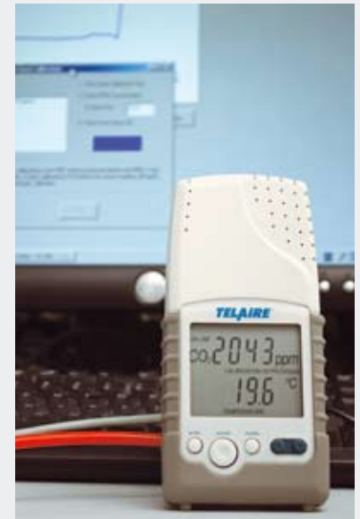
CO 2 -kalibratie op meerdere meetpunten met gecertificeerde ijkgasen
